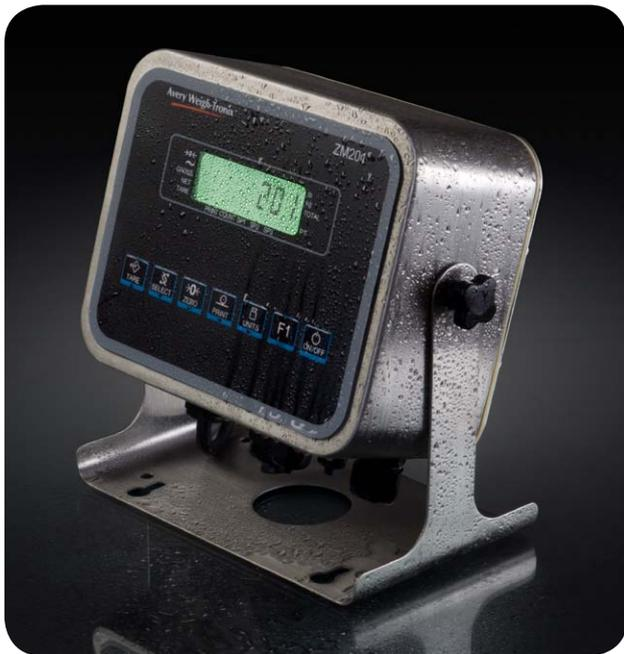
Das ZM201-Edelstahlmodell verfügt über patentierte abgerundete Ecken nach IP66, speziell konstruiert für die Verdrängung von Wasserrückständen bei der Reinigung in Anwendungen der Lebensmittelverarbeitung.
