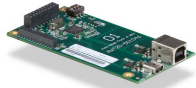
USB-Gerätekarte USB-Schnittstelle zum PC.
