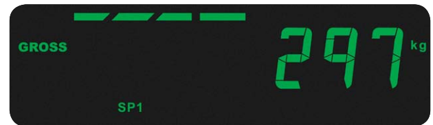
Mehrsegment-Anzeige für Anwendungen im Bereich des Prüfwiegens und der Prozesskontrolle
