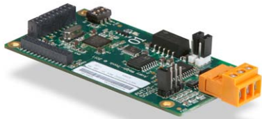
Analoge Ausgabekarte 0-10 Volt Gleichspannung und 4-20 mA.
